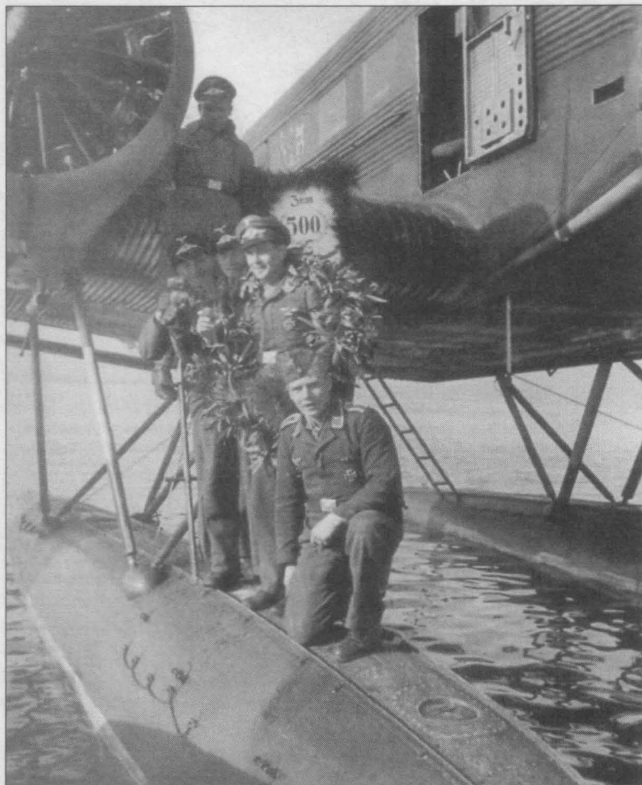
Экипаж гидросамолета Ju-52/3m (See) - два пилота, радист и два стрелка. Скорее всего, снимок сделан в честь 500-го боевого вылета самолета неустановленного штаффеля. На снимке хорошо видны N-образные и V-образные подкосы, на которых поплавки крепятся к фюзеляжу самолета. Дверца в правом борту фюзеляжа полностью распахнута. Ниже окон в борту фюзеляжа виден поручень.
