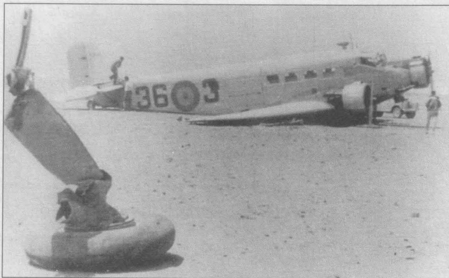
Самолет CASA-352L (36-3) потерпел аварию из-за поломки шасси при посадке в Испанской Сахаре. На переднем плане - часть правой основной опоры шасси с колесом. Ju-52/3m испанского производства имели удлиненные капоты двигателей.
