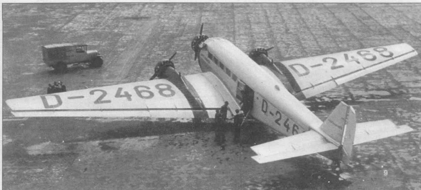
Самолет Ju-52/3m се (D-2463, Werk Nr. 4019) авиакомпании Дойче Люфтганза - последний предсерийный пассажирский самолет, построенный на заводе фирмы Юнкерс в Дессау. На верхней поверхности фюзеляжа хорошо виден воздухозаборник для вентиляции кабины. Самолет имеет цвет неокрашенного металла, только полосы на крыле, носовая часть фюзеляжа и надписи - черные. После смены в 1934 г. системы регистрационных обозначений летательных аппаратов Германии, самолет получил регистрационный номер D-AFIR.
