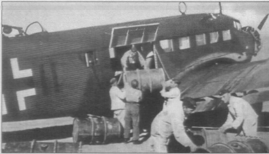
Наземный персонал загружает в кабину самолета Ju-52/3m g5e бочки с горючем, предназначенным для корпуса «Африка», аэродром на Сицилии. Самолеты Ju-52/3m g4e и Ju-52/3m g4e имели небольшое дополнительное окно в борту фюзеляжа за грузовой дверью. В проеме этого окна мог устанавливаться 7,92-мм пулемет MG-15.
