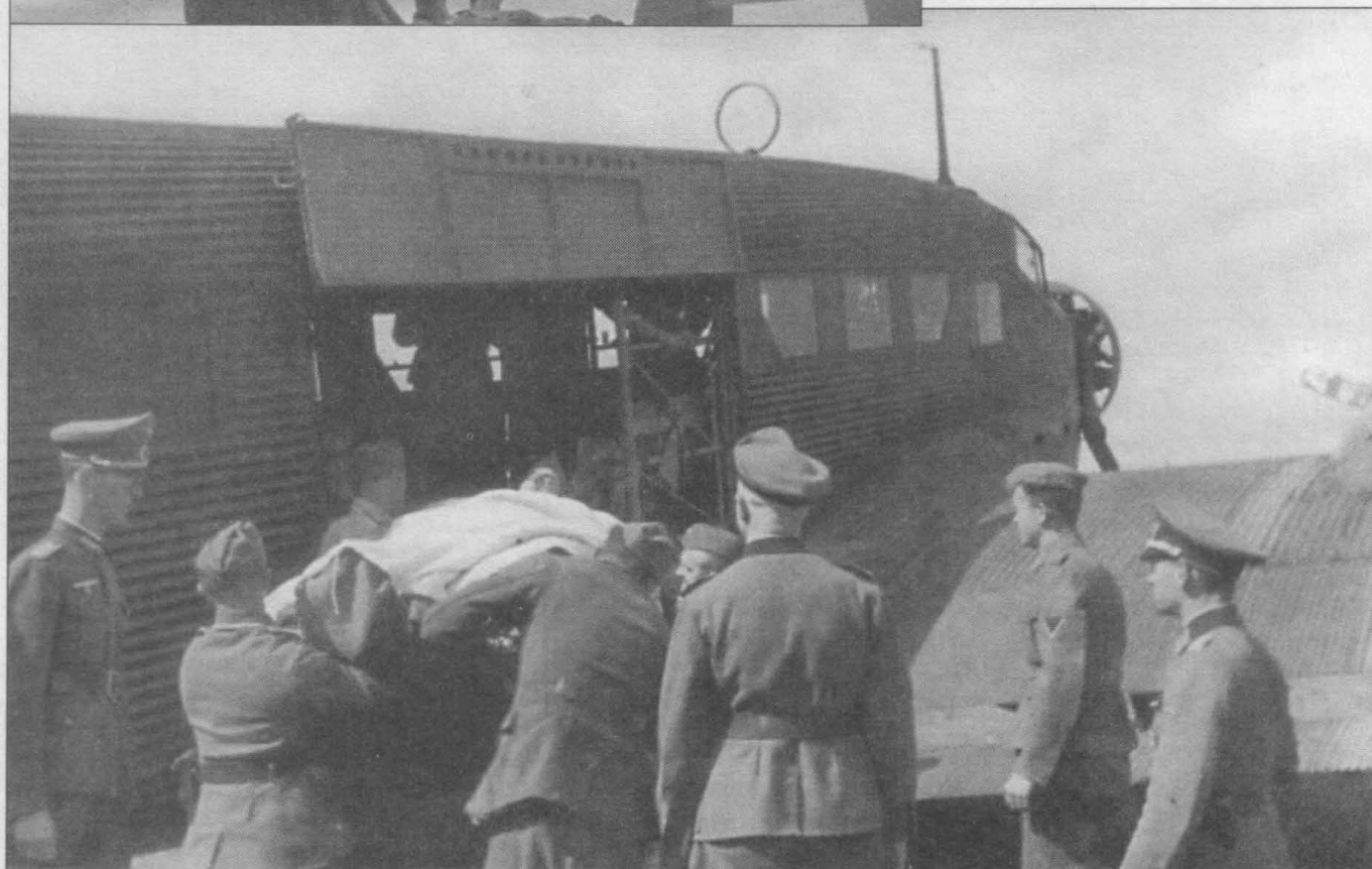
Офицер вермахта наблюдает за погрузкой раненых солдат в кабину самолета Ju-52/3m g7e. Верхняя створка грузового люка зафиксирована в открытом положении. Ju-52/3m мог перевозить до 12 раненых на носилках и одного медицинского работника.
