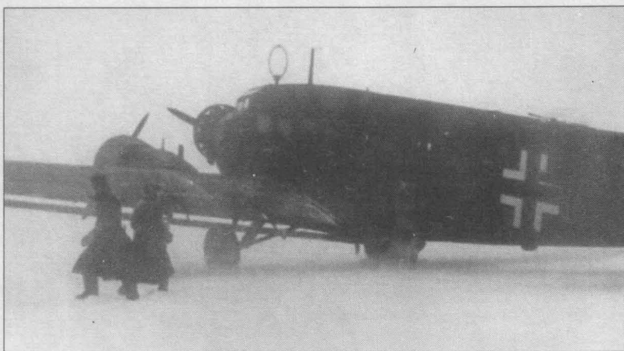
Ju-52/3m g3e (1G+EK) из KG-27, Восточный фронт. Верхняя стрелковая точка закрыта плексигласовым колпаком от стрелковой точки бомбардировщика He-111 (на снимке колпак виден плохо). Колпак, в гораздо большей степени, чем козырек, защищал стрелка в полете от потока обжигающего морозного воздуха.
