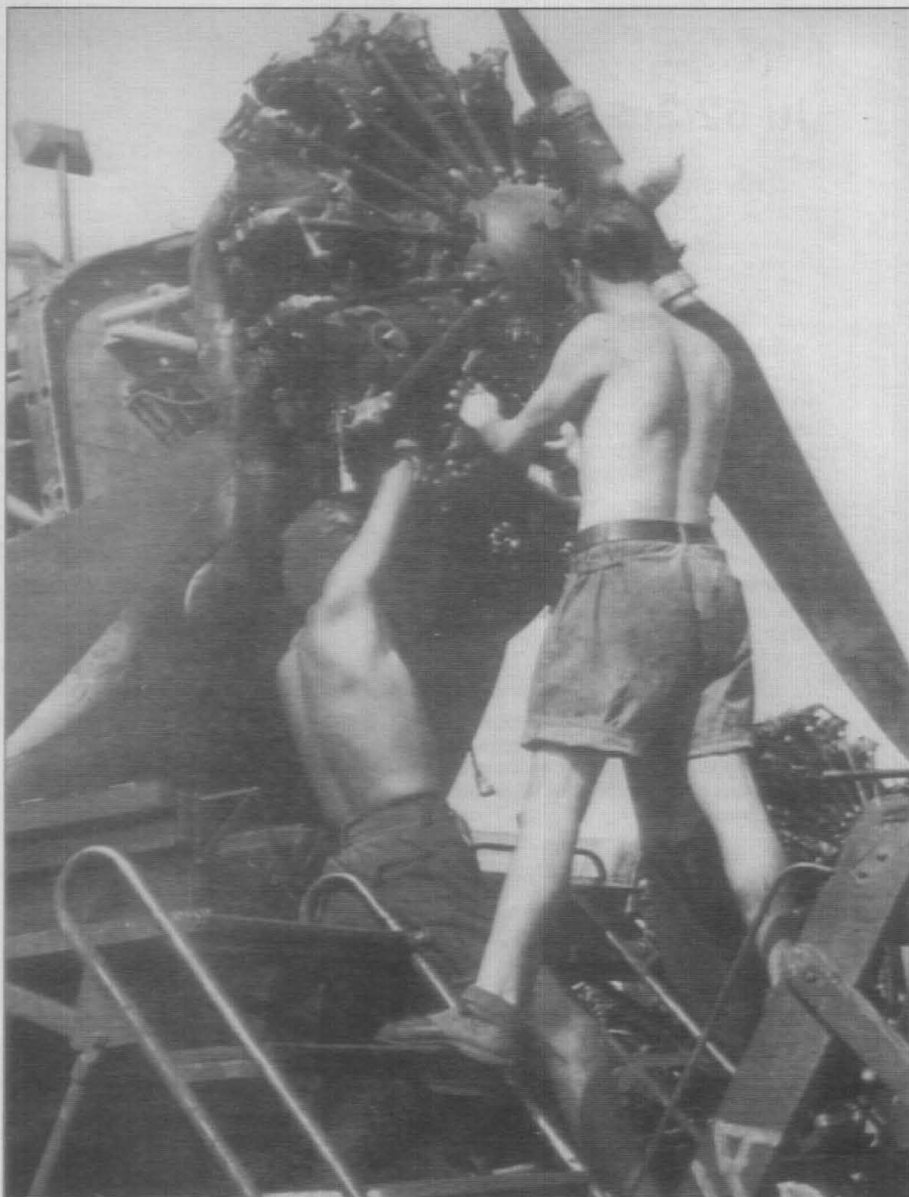
Два механика, стоя на импровизированной платформе, ремонтируют средний мотор самолета Ju-52/3m. Кольцо Тауненда с двигателя снято. Хорошо виден на снимке двухлопастный металлический воздушный винт изменяемого шага. Мощность двигателя BMW-132 возросла с 725 л.с. на модели BMW-132A-3, стоявшей на самолетах Ju-52/3m g3e до 830 л.с. у варианта BMW-132L самолета Ju-52/3m g14e.
