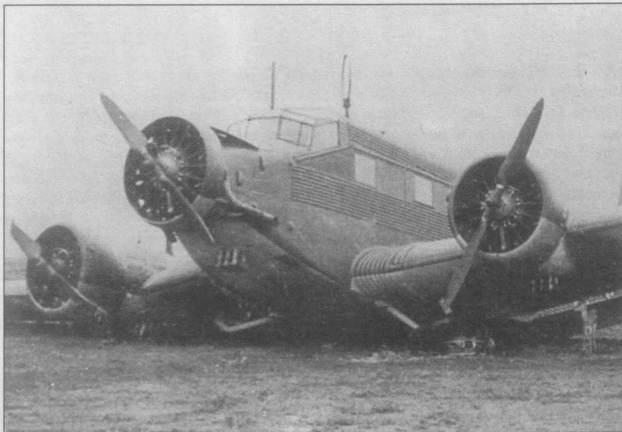
Ju-52/3m g3e подломил стойки основных опор шасси при грубой посадке. На снимке - один из немногих самолетов, у которых под двигателями ставилось по три масло-радиатора.
