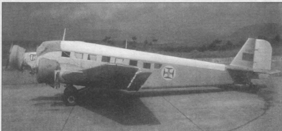
ААС-1 (6320) - один из 13 «Туканов», которые после снятия с вооружения ВВС Франции передали в декабре 1960 г. в ВВС Португалии. На фюзеляже установлена вторая мачта натяжной радиоантенны, вторая мачта - стандартный вариант для Ju-52/3m французской постройки. Верхняя часть фюзеляжей португальских Юнкерсов окрашивалась в белый цвет, все остальное - цвет натурального металла.
