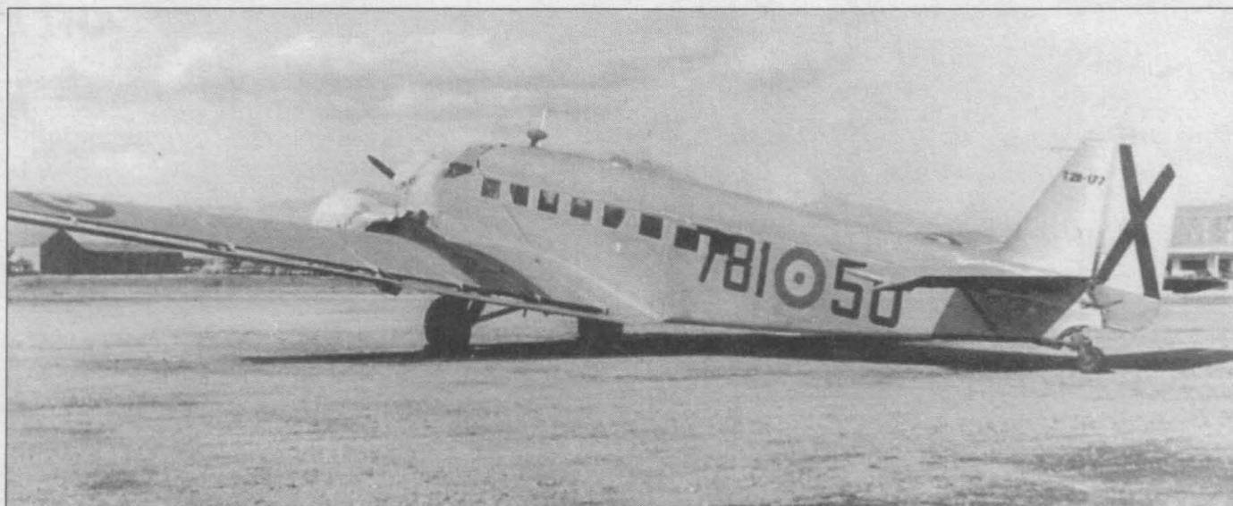
Самолет CASA-352L (781-50) ВВС Испании. В ВВС самолет обозначался Т.2В. На киле написан идентификационный номер и обозначение машины: Т.2В-177 - это один из последних построенных CASA-352L. В передней части фюзеляжа в каплеобразном обтекателе установлена антенна радиоконпаса.
