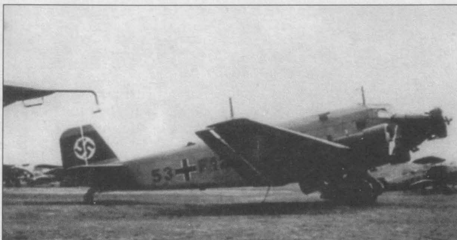
Бомбардировщик Ju-52/3m g3e (53+F12) на аэродроме люфтваффе, середина 30-х годов. Обратите внимание на совершенно необычную для Ju-52/3m g3e установленную на конце правой плоскости крыла радиомачту. Самолет модификации g3e стал первым Ju-52/3m, принятым на вооружение люфтваффе. По требованию военных по правому борту фюзеляжей всех самолетов ставились электрогенераторы с приводом от набегающего потока воздуха.
