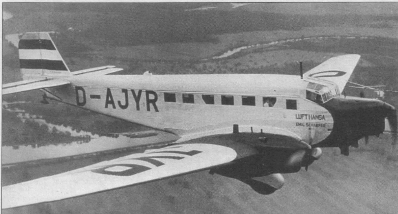
D-AJYR «EMIL SCHAEFER» (Werk Nr. 4045) - один из двух построенных Ju-52/3m ho. На данной модификации стояли 12-цилиндровые дизельные двигатели Юнкерс Jumo-205. Оба самолета летали в 1933-1935 г. в Люфтваффе. В 1933-1935 г.г. на правую сторону вертикального оперения наносился тогдашний национальный флаг Германии - черно-бело-красный (сверху вниз), а на левый - свастика.
